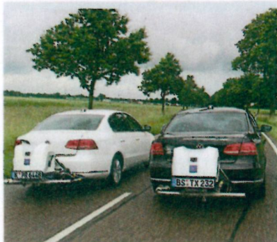
Der Stickoxidausstoß wurde im Fahrbetrieb mit PEMS-Messgeräten ermittelt
