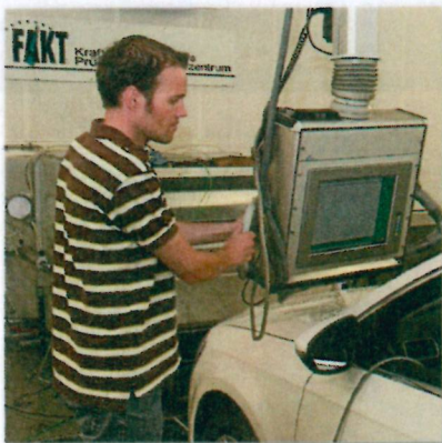
Im Prüflabor Fakt wurden auf dem Prüfstand Leistung und Drehmoment gemessen
